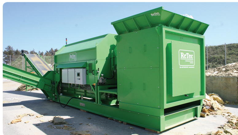
ReTec mineraluld recycler er opbygget på en praktisk ramme, så den let kan flyttes.
