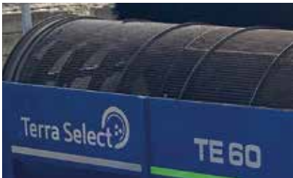
2,200 mm trommel diameter
